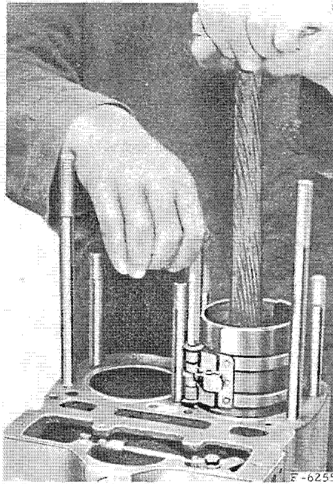
Fig. 49 - Installation de l'ensemble bielle-piston avec un compresseur à segments.
